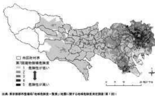
地震による建物倒壊危険度 (東京都)
